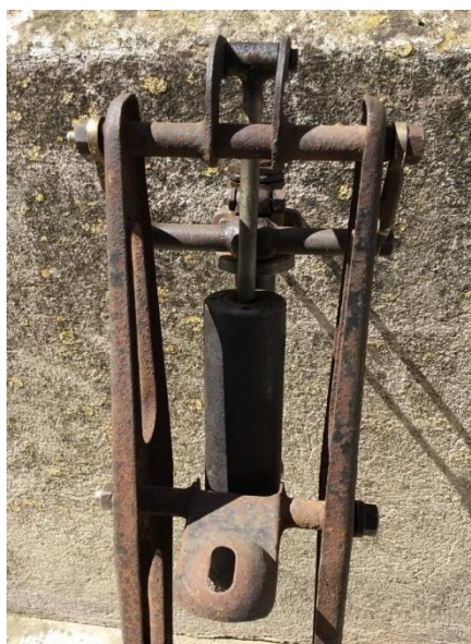
La fourche R2 a son arrivée équipée avec son amortisseur
