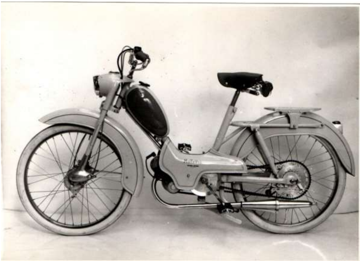
Motavia série CL2 suspension oscillante le compteur incorporé est un supplément
