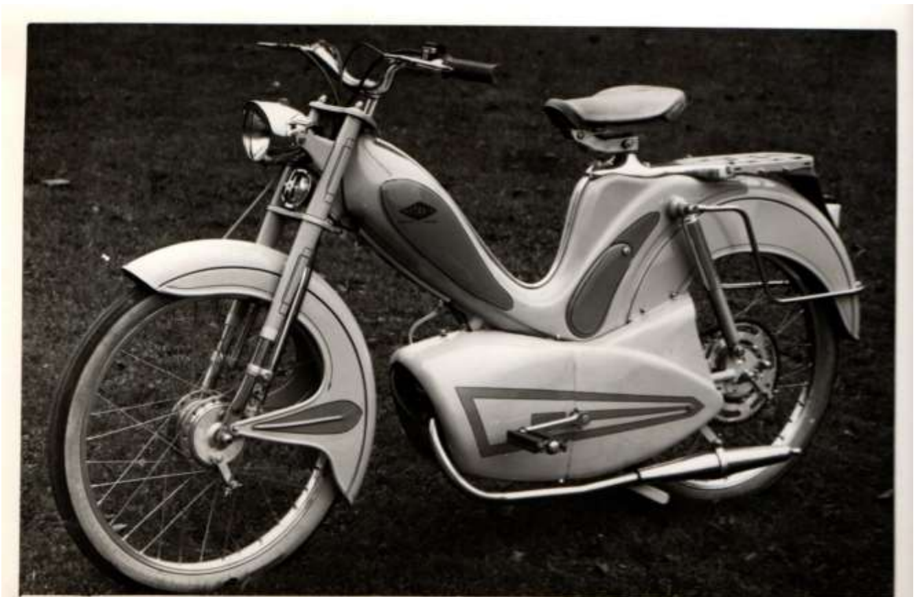
« Cadre poutre » fourche télescopique suspension AR oscillante grand débattement de 60mm Protection totale démontable instantanément garde boues très enveloppants
