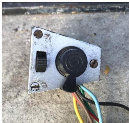
Pour le klaxon, il suffit d'appuyer sur le bouton de droite quel que soit la position.
