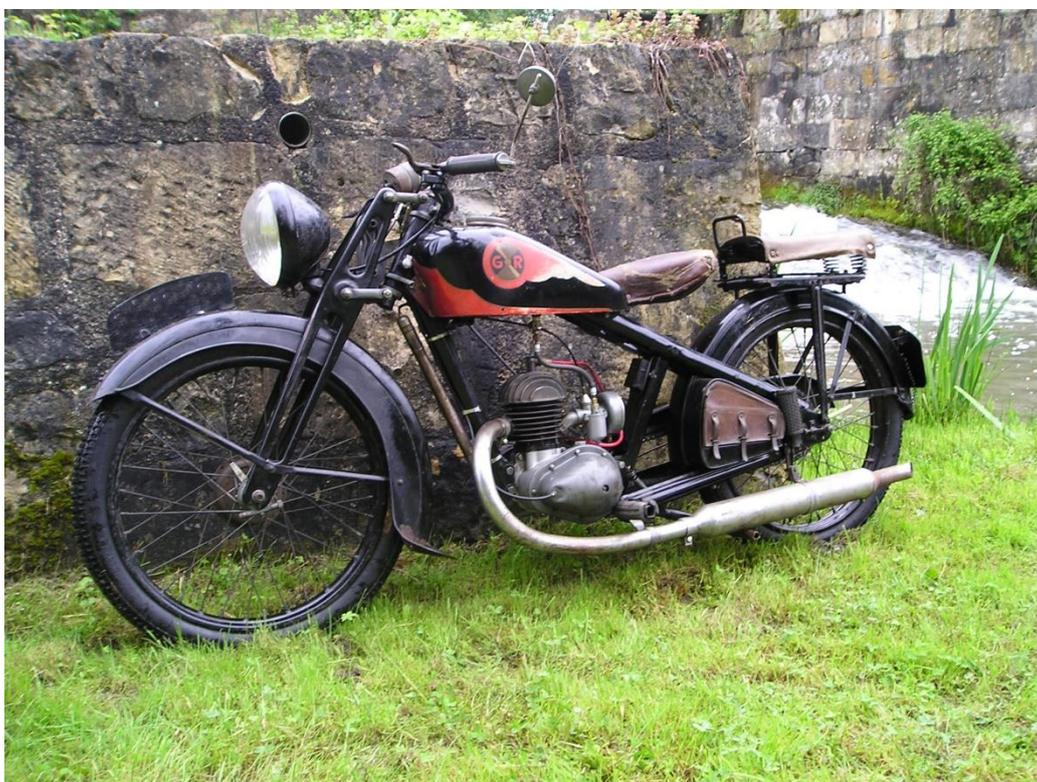
Coté moteur, bien sûr la cylindrée passe de 100 à 125 cm<sup>3</sup> ce qui entraîne les modifications nécessaires des carter, de l'embellage, de l'ensemble piston/cylindre/ culasse et du carburateur qui désormais placé à l'arrière du moteur.
